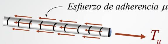
De esta manera, para que la varilla esté en equilibrio, deben existir esfuerzos de adherencia que si desaparecieran, la barra se "extraería" del volumen de concreto haciendo que la tensión  $T$  se anule y la viga eventualmente colapse.
